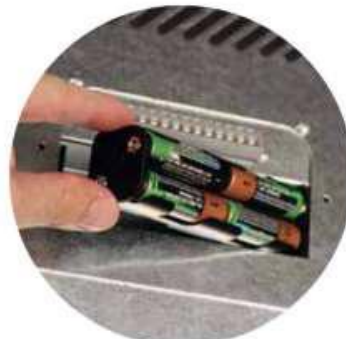
Figure 20 - Batterie de backup
